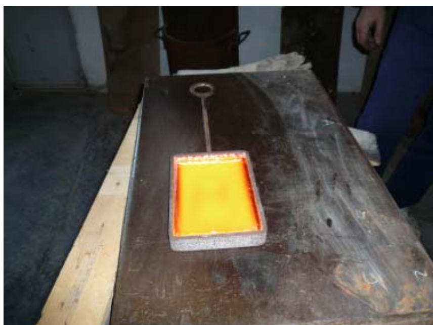
operazione di colatura di una formella
