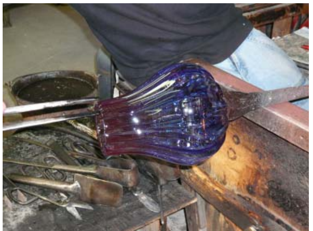
Lavorazione di un vaso con la tecnica tradizionale, è da notare l'attrezzatura estremamente semplice che viene utilizzata dal maestro
