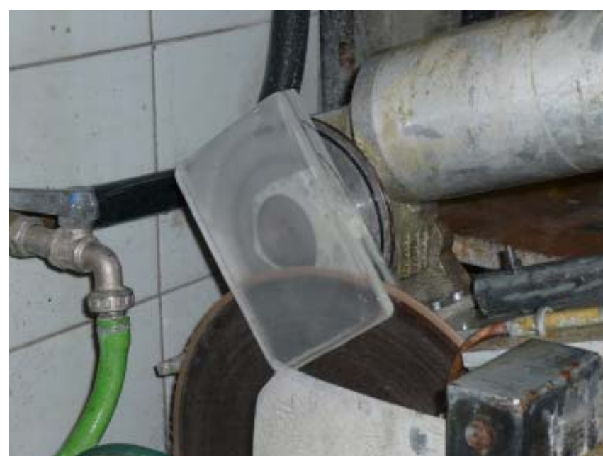
taglio di una formella per ricavare due lastre del giusto spessore
